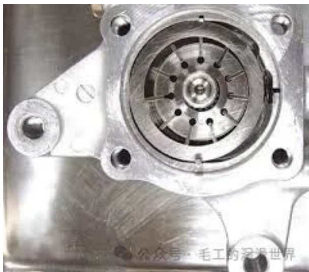
图2 滑片-气缸声摩擦副示意图
