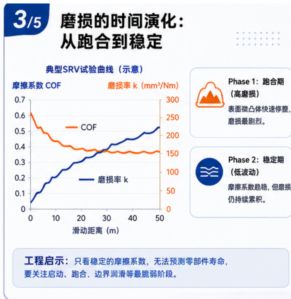
图2 SRV试验曲线：摩擦系数与磨损率的时间演化
