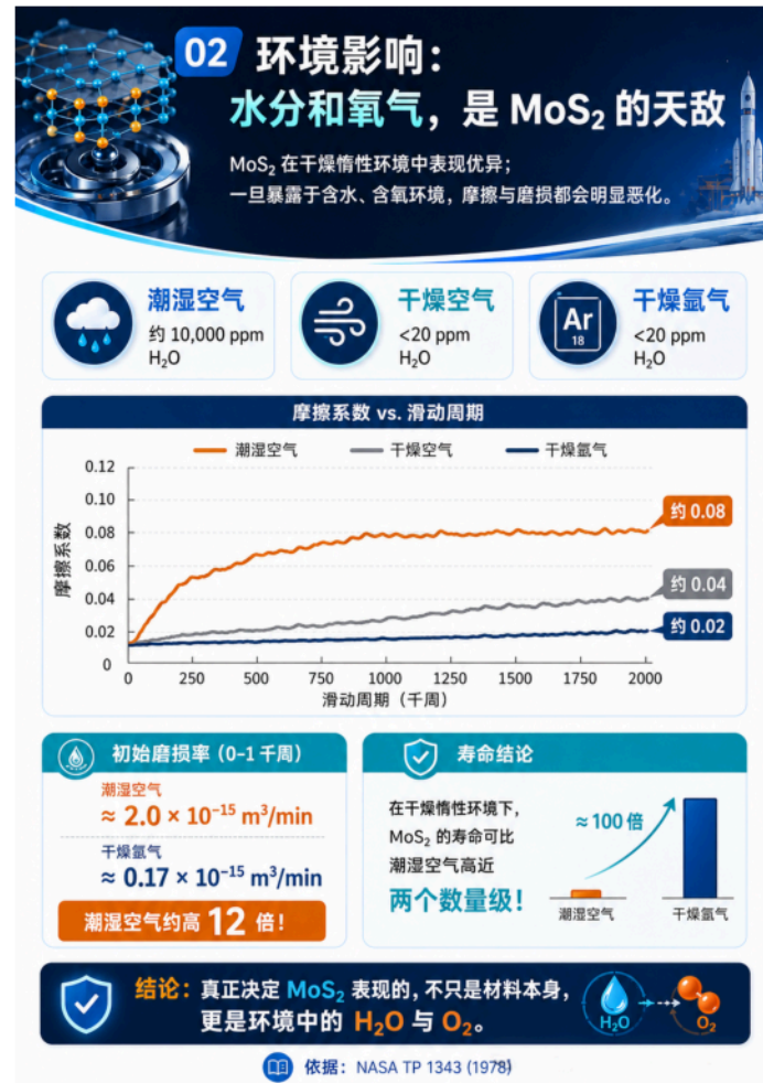
图2 不同环境条件下MoS 2 的摩擦系数与磨损率对比
